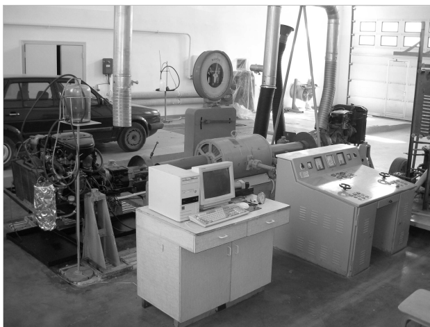
2. att. Motoru izmēģinājumu stends Rapido VEM-100 LLU Spēkratu institūta laboratorijā (2006).
